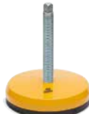
Part. R0406 - Pag. R51 Ø 123 • Acciaio verniciato • Carico max. 50000 N.
